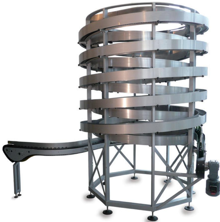
新型AccuVeyor® AVs是一种缓存/储存系统，旨在很小的面积上创建出很长的传送带。AccuVeyor® AVs是AccuVeyor® 产品家族中最年轻的成员，该产品家族能够为许多行业提供解决方案。为了在各种过程（比如冷却、缓存和烘干）中增加“时间”，AccuVeyor® AVs将在单个输送道上传送单个产品。紧凑而简洁的设计使之成为了一种创新解决方案，能够真正满足您的需求。相比传统的水平系统而言，AccuVeyor® AVs节省了宝贵的地面空间。
